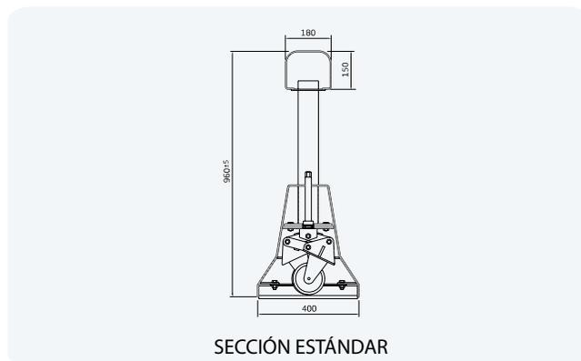
La barrera metálica "VGH-960" incorpora un mecanismo de ruedas. Mediante el accionamiento de un husillo al efecto, se levanta ligeramente la barrera quedando apoyada sobre las ruedas. Esto permite el desplazamiento transversal del sistema.
